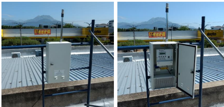
Ilustración 4. Equipo automático de calidad del aire – Estación Corpocesar.
