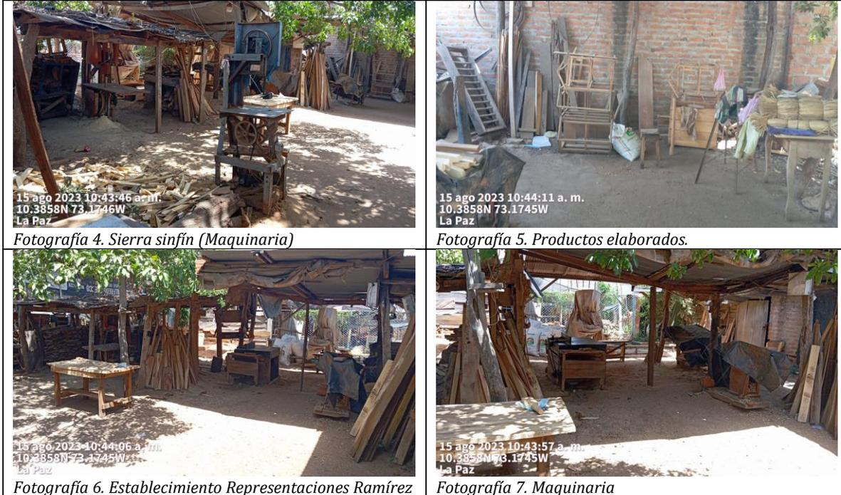
La operación tiene un porcentaje de pérdida de materia prima del 20 % entre aserrín, trozos, rechazo y cortes de madera, debido al espesor de las cuchillas o herramienta de corte de la maquinaria y tipo de producto a elaborar.
