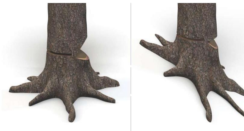
Ilustración 1. Corte Direccional.
