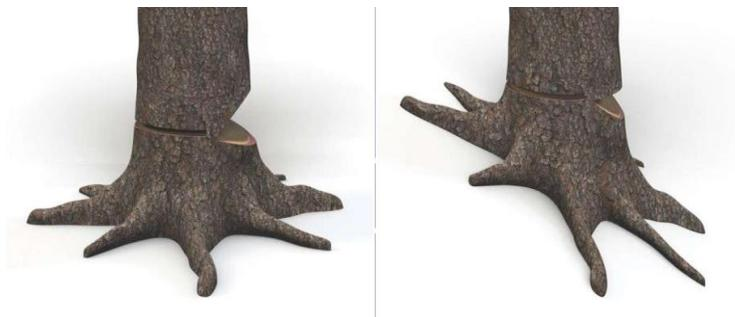
Ilustración 1. Corte Direccional.
