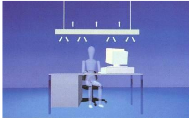
Imagen 2. Vista frontal de la ubicación ideal de la luminaria con respecto al área de trabajo de forma paralela
